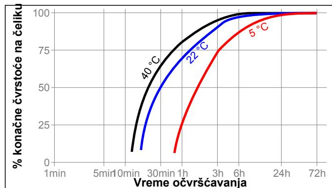
**Brzina očvršćavanja u zavisnosti od upotrebljenog aktivatora**
